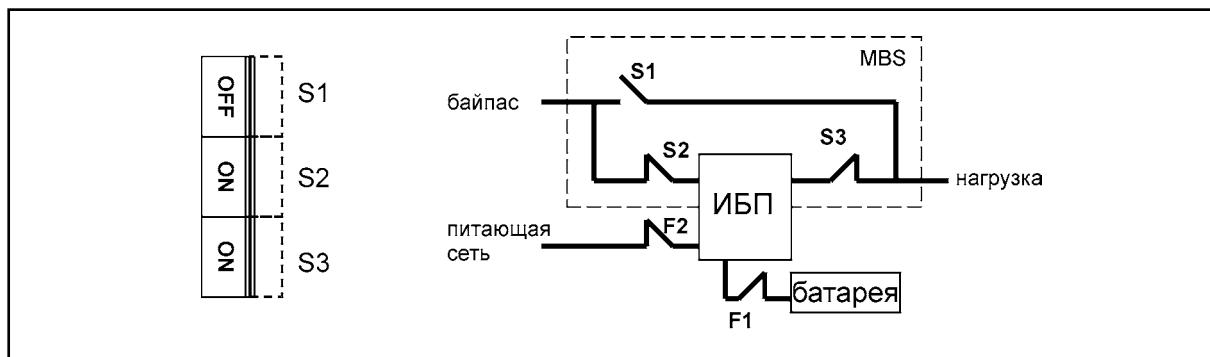
Рисунок 17 Нормальное положение выключателей MBS (ИБП питает нагрузку).
