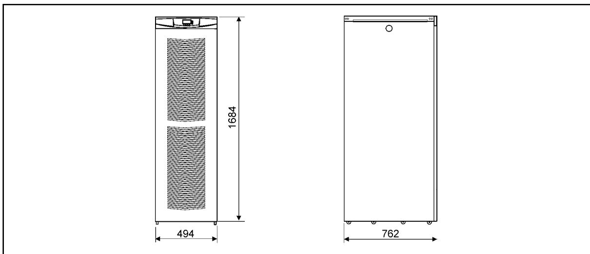
**Рисунок 26** Габариты ИБП.
