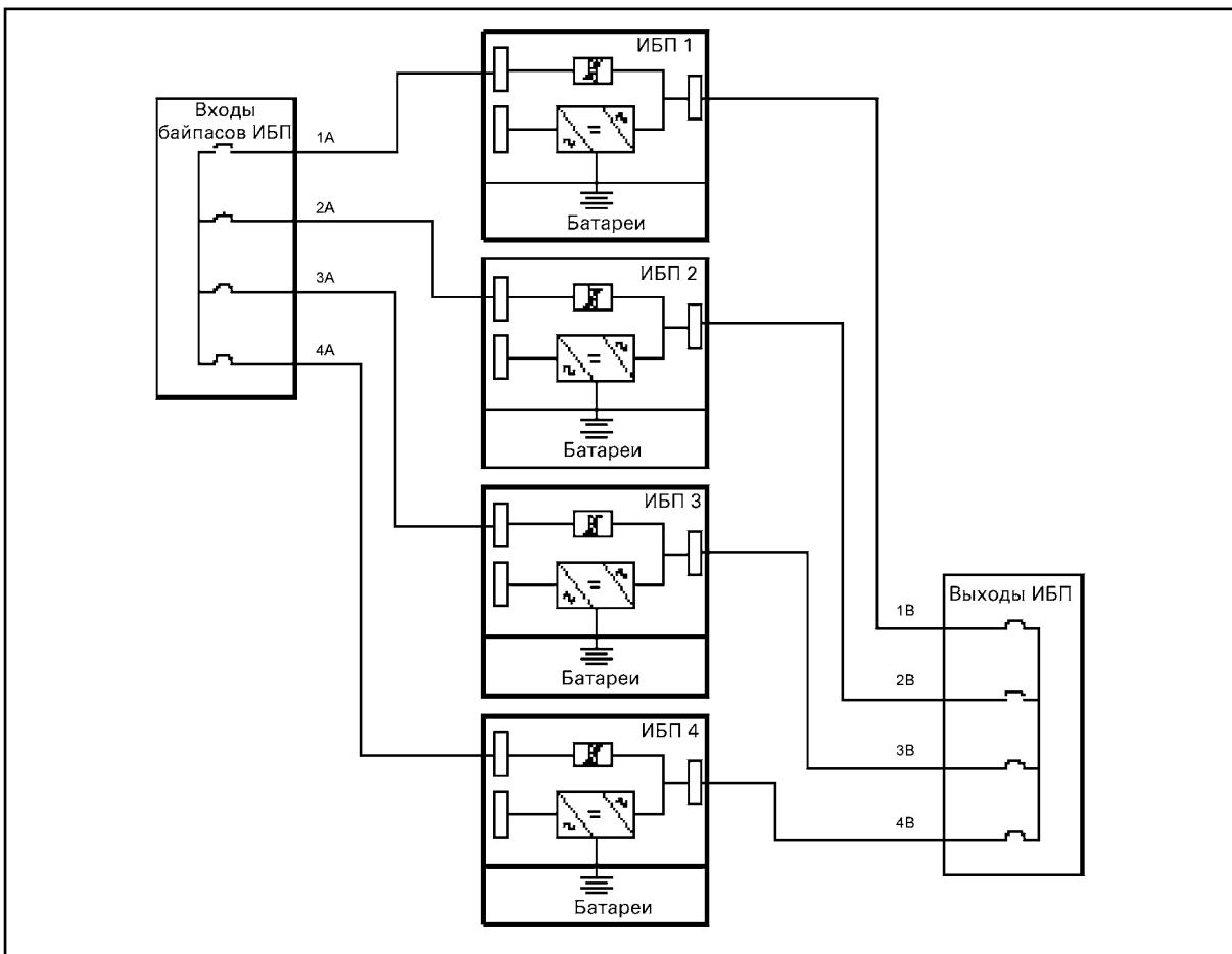
**Рисунок 21** Схема байпаса и обозначения длин кабелей
