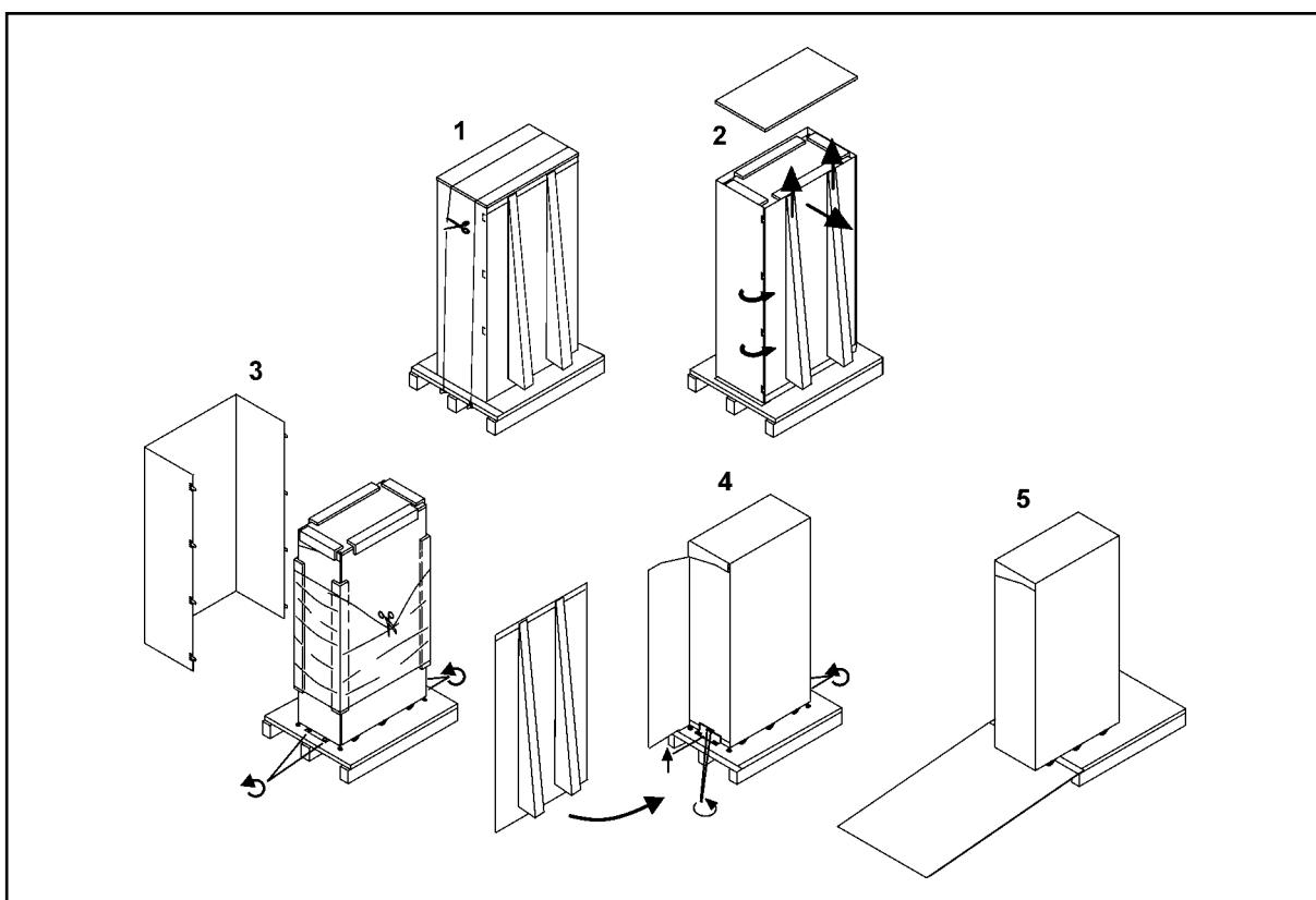
**Рисунок 3. Инструкции по снятию оборудования с поддона.**
