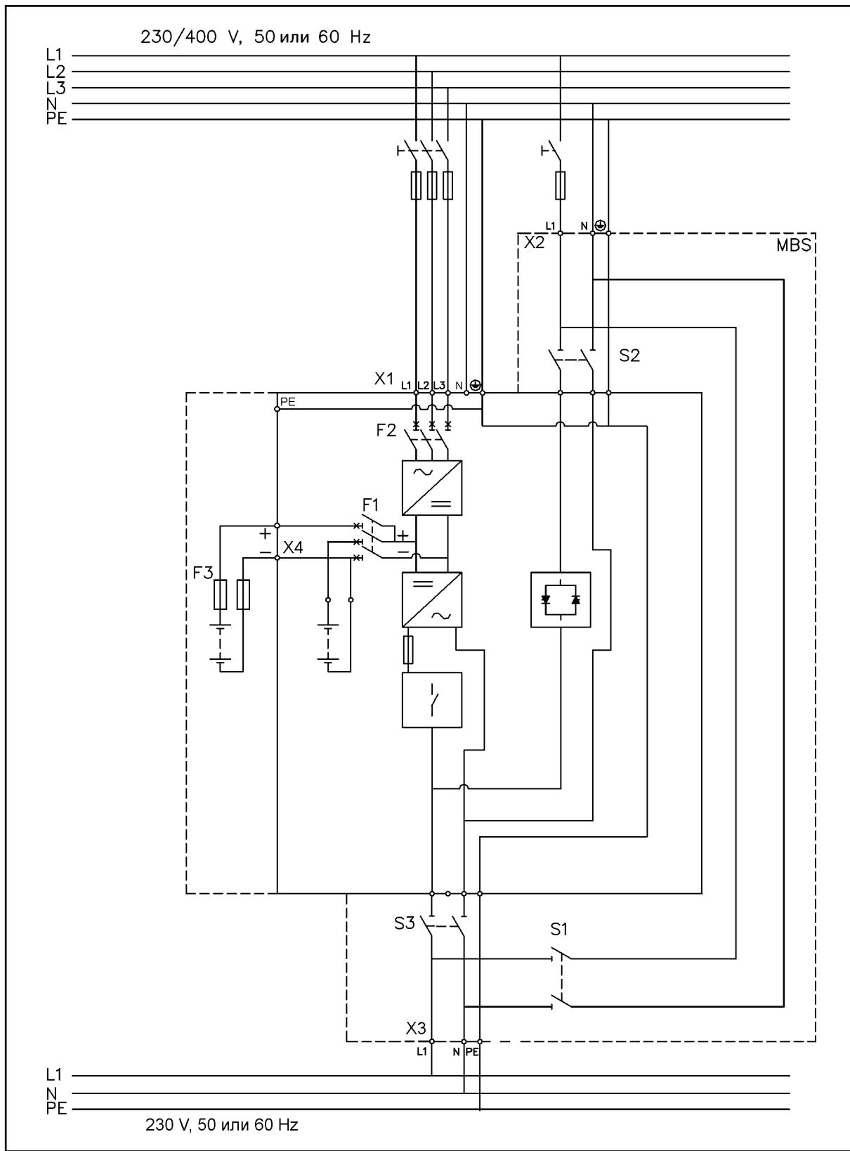
**Рисунок 7** Схема подключения ИБП модели Н (3-фазный выпрямитель) с встроенным ручным обходным переключателем (MBS).
