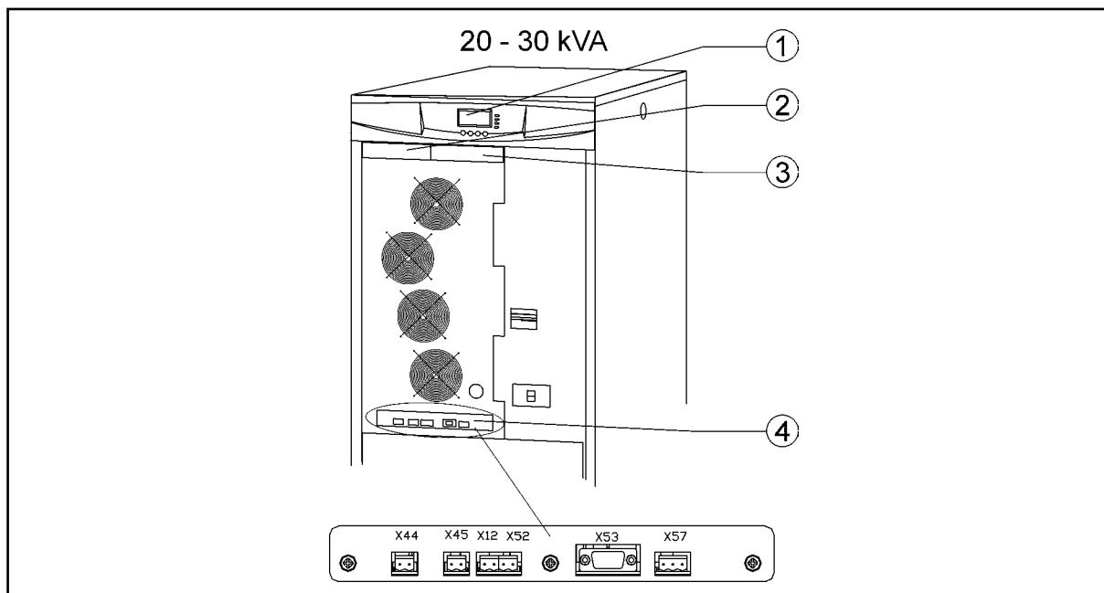
**Рисунок 9** Расположение разъемов управляющего кабеля и ЖК дисплея: 1:Графический ЖК дисплей; 2:XSlot-1; 3:XSlot-2; 4:Входы сигналов (X44 &X45); EPO (NC (X12) & NO (X52)); RS-232 (X53); релейный выход (X57).
