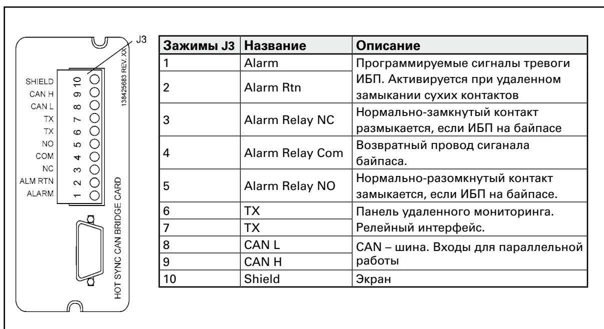
**Рисунок 22** Адаптер XSlot Hot Sync и контактный интерфейс
