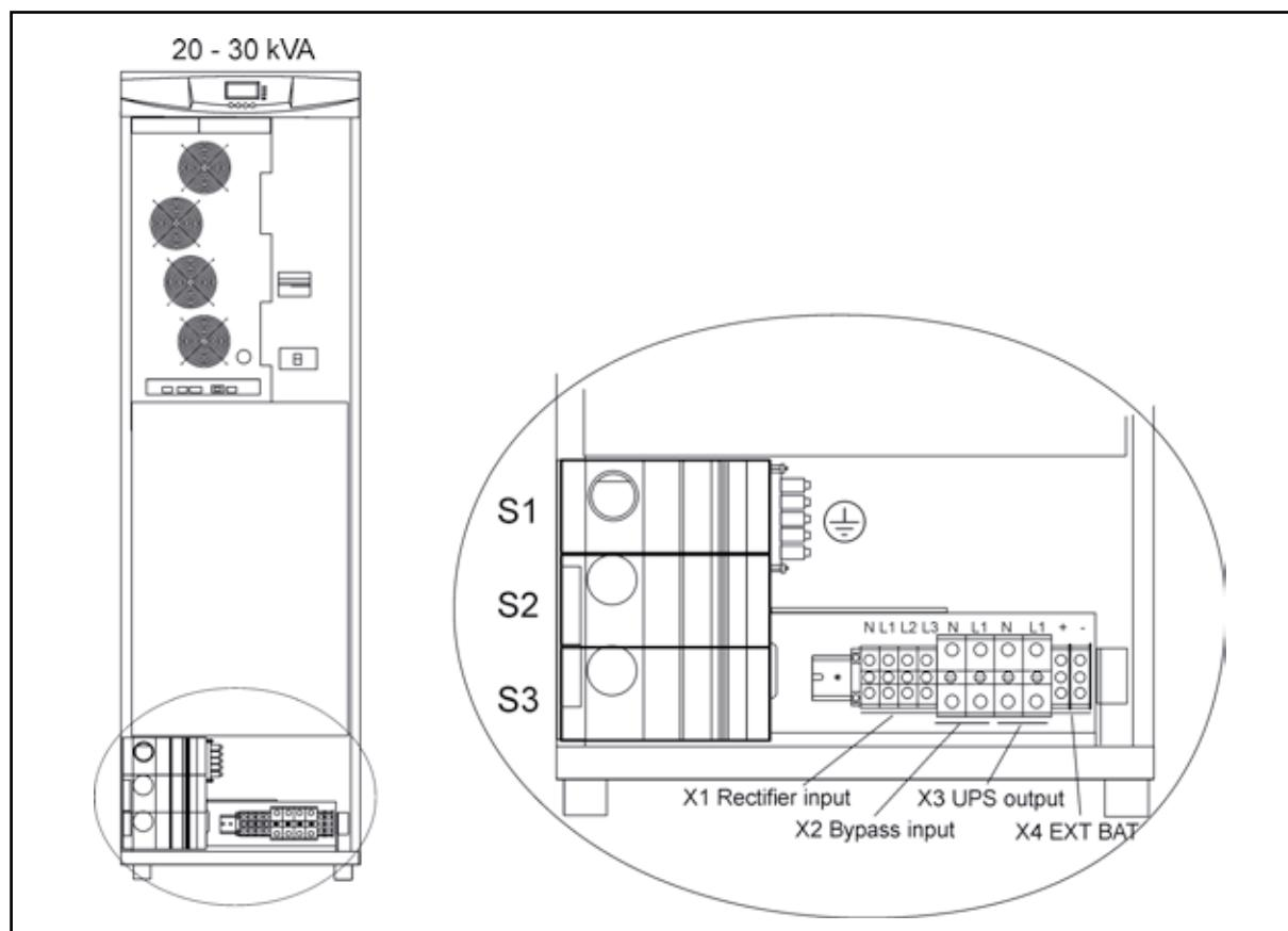
**Рисунок 6.** Расположение силовых клемм. S1:Переключатель сервисного байпаса; S2: Переключатель входа статического байпаса; S3:Переключатель выхода ИБП. Убедитесь, что батарейный выключатель разомкнут. Отключите все внутренние батареи перед тем, как работать с клеммой X4.
