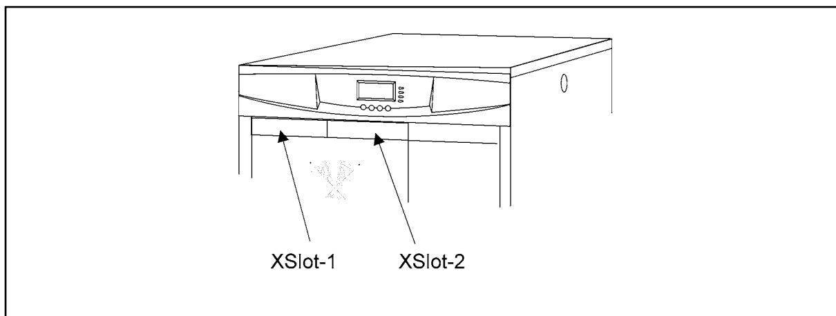
**Рисунок 12** Расположение пустых гнезд для установки устройств XSlot.
