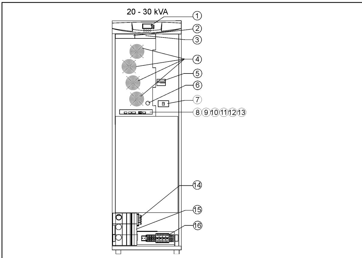
**Рисунок 5** Схема Powerware 9155 20-30 кВА: 1:Графический ЖК дисплей; 2:XSlot-1; 3:XSlot-2; 4:Вентиляторы; 5:Входной (выпрямительный) выключатель; 6:Кнопка запуска батарей; 7:Выключатель батарей; 8-13:Разъемы для подключения; 14:Разъем заземления; 15:Ручной обходной переключатель (MBS); 16:Разъемы силовых кабелей
