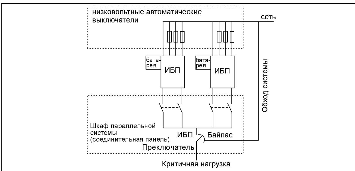
**Рисунок 25.** Переключатель сервисного байпаса системы модуля параллельной работы
