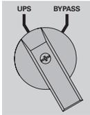
12. Установите ручной переключатель Bypass (Байпас) MBR в положение "**UPS**" (ИБП): гаснет **красный индикатор MBR "Bypass mode"** (Байпасный режим), это означает, что в настоящее время нагрузка питается от ИБП
