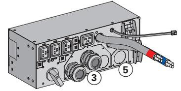
3. Пропустите силовой кабель (сечение кабеля указано в пункте 3.5) через кабельный ввод в крышки входа байпаса MBR (5) (этот кабель не включен в комплект).
