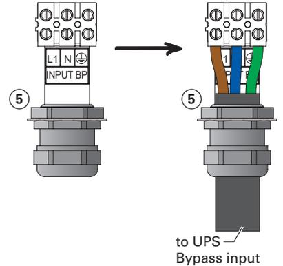
4. Подключите провода к клеммным колодкам "Input BP" (Вход BP) крышки ввода байпаса MBR (5).
