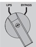
3. Установите ручной переключатель Bypass (Байпас) МВР в положение "**UPS**" (ИБП): гаснет красный индикатор МВР "**Bypass mode**" (Байпасный режим), это означает, что в настоящее время нагрузка питается от ИБП
