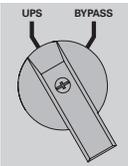
8. Установите ручной переключатель байпаса **МВР** в положение "**UPS**" (ИБП); гаснет красный индикатор МВР "**Bypass mode**" (Байпасный режим), это означает, что в настоящее время нагрузка питается от ИБП
